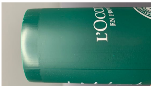
Illustration 6 : Rayures pendant l'extrusion
